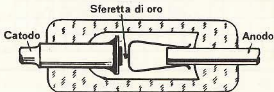
Fig. 17 - Struttura di un diodo di commutazione al silicio (Siemens BAY 43).
